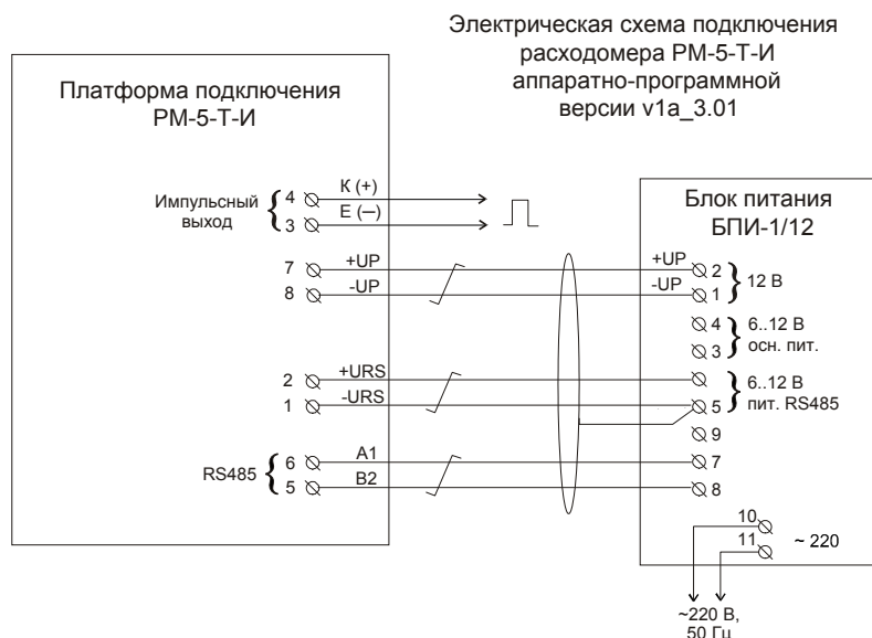
Рисунок Д.1 — Базовая электрическая схема подключения РМ-5-Т-И к блоку питания БПи-3В с технологическим каналом RS-485
