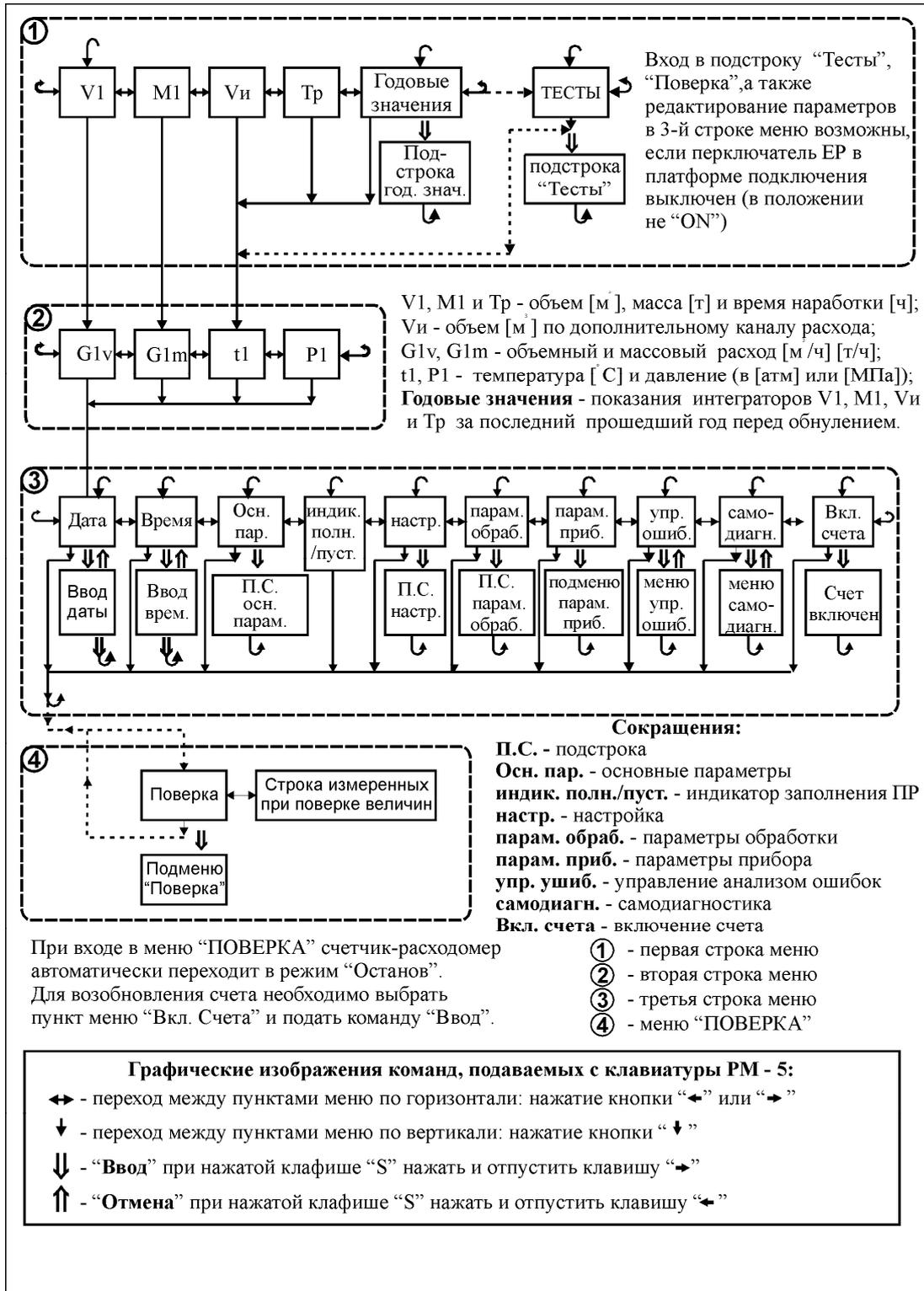
Рисунок Ж.1— Структура основного меню вычислительного устройства
