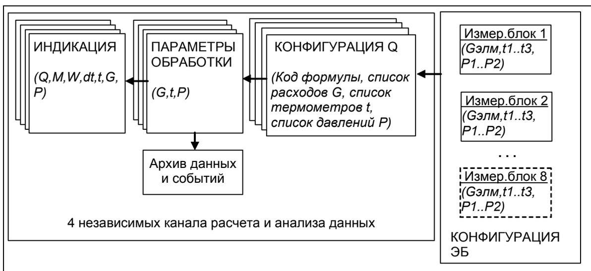
Рисунок Н.2 — Схема обработки данных в РМ-5-Б1
