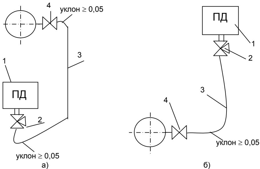
Рисунок 12 — Схемы присоединения датчиков давления на измерительном участке
