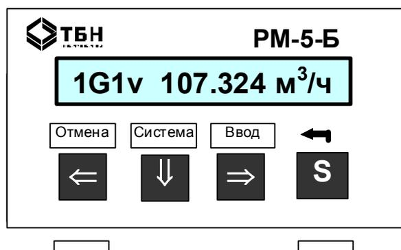
Рисунок 4 — Внешний вид ИВБ – вычислительного устройства РМ-5-Б1
