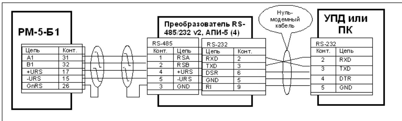
Рисунок Р.1— Схема монтажа для подключения через преобразователь интерфейса
