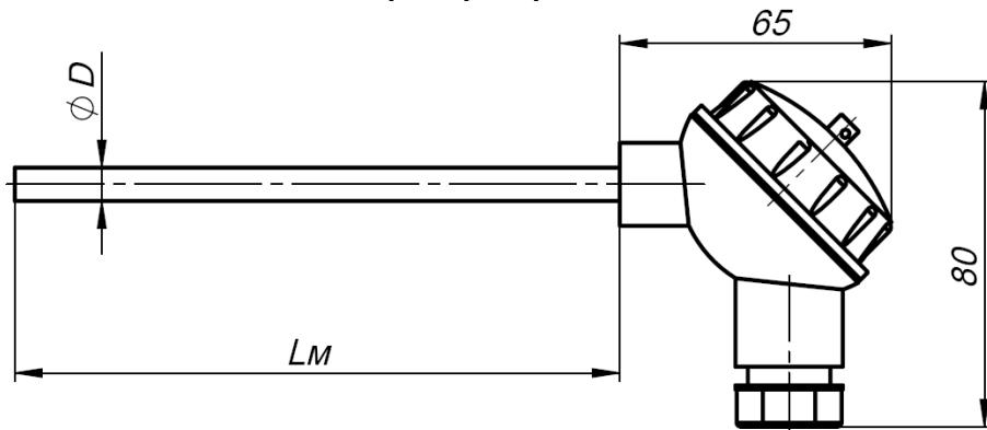
Диаметр монтажной части D, мм: 6; 8.
