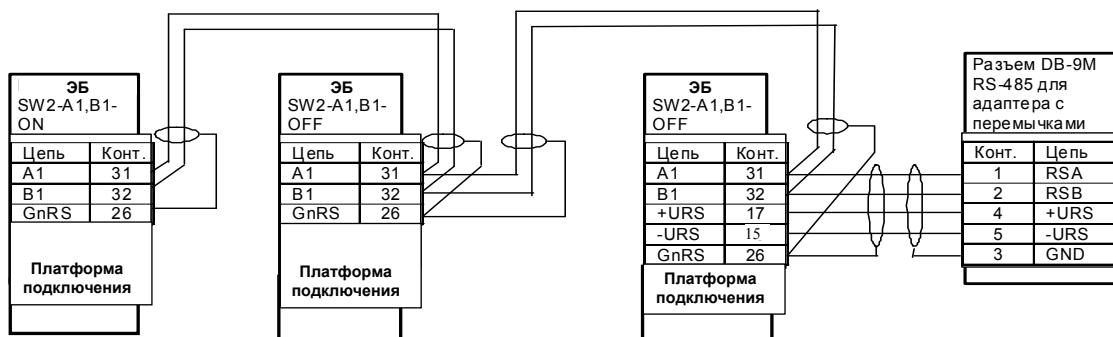
Рисунок Р.3 — Типовая схема сетевого соединения РМ-5-Б1
