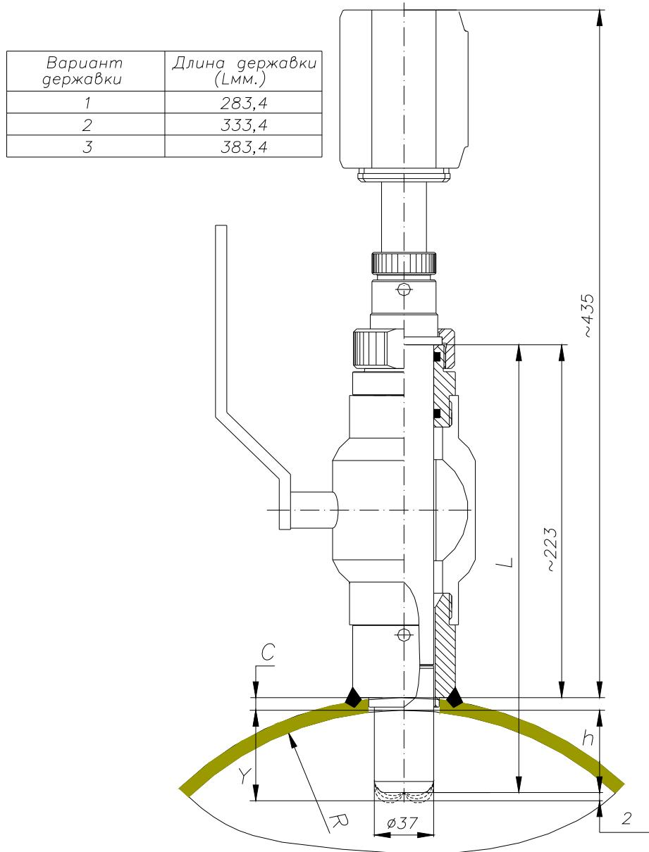
Рисунок В.2 — Внешний вид и габаритные размеры преобразователя скорости ПС
