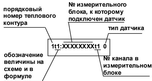
Рисунок Н.1 — Формат отображения конфигурации датчиков
