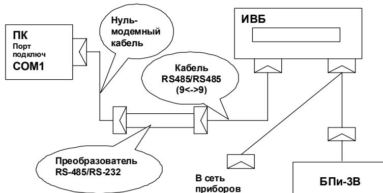
Рисунок Н.3 — Схема соединений для конфигурирования ИВБ с компьютера
