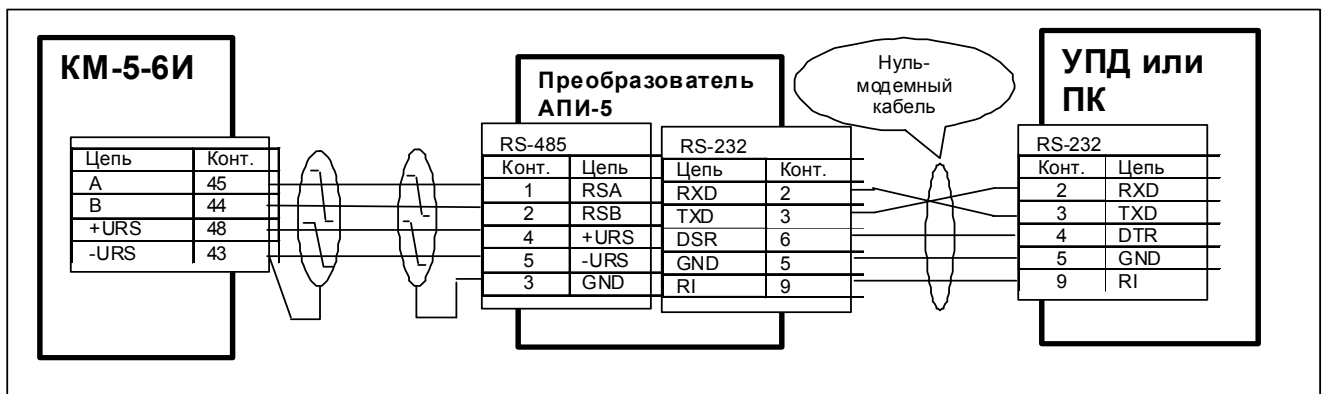
Рисунок Д.1 — Схема монтажа для подключения через преобразователь интерфейса
